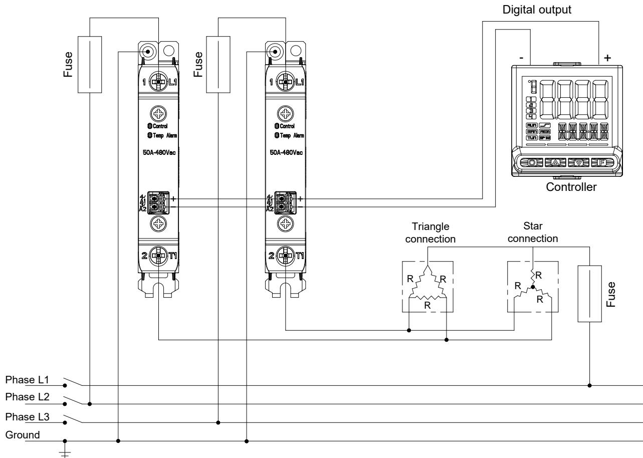
Connexion triphasée, étoile, avec neutre - *Three-phase Wye connection with neutral*
