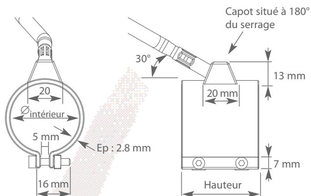
A chaque diamètre de collier, correspond une capacité de serrage. Exemple, un collier de diamètre 30 mm peut être monté sur des fourreaux de diamètre 30 mm à 31 mm.
