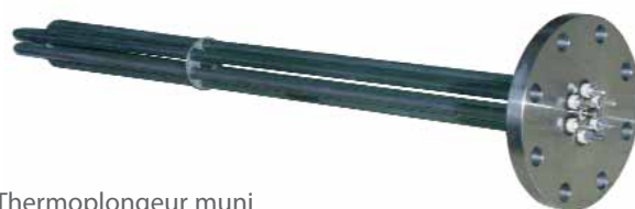
Thermoplongeur muni d'une entretoise, pour maintenir les épingles de grande longueur. Photo : thermoplongeur 30 kW, longueur sous bride LT : 900 mm
