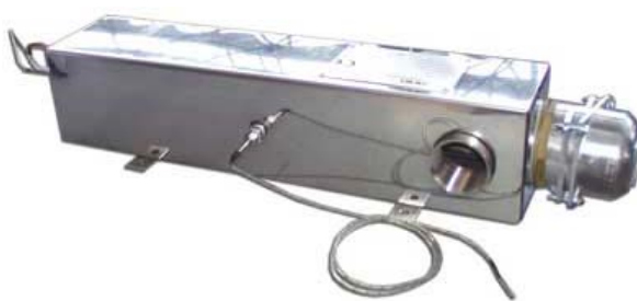
3 kW - Réchauffeur avec jaquette calorifugée en inox, corps de chauffe DN 80, longueur 730 mm sonde de régulation et sonde de sécurité.
