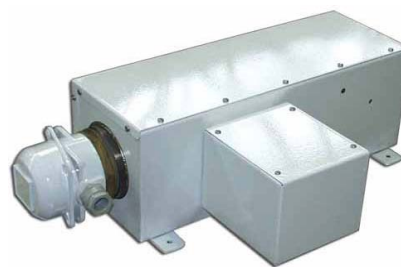
9 kW - Réchauffeur calorifugé corps DN 100, longueur 460 mm thermostat sous boîtier
