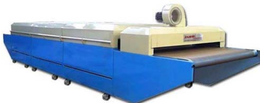
Tunnel modulaire, composé d'une section air chaud à convection forcée, d'une section infrarouge et d'un caisson de refroidissement. Longueur de traitement : 9 400 mm. Largeur 2100 mm. Fourni avec coffret électrique latéral.
