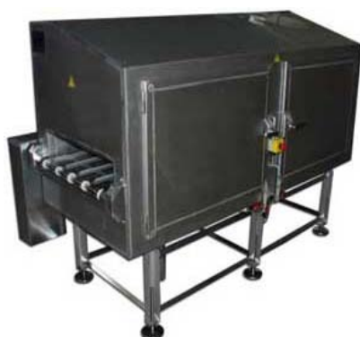
Tunnel air chaud, pour produits alimentaires. P : 10 kW Longueur de traitement 2000 mm . Fourni avec coffret électrique indépendant.
