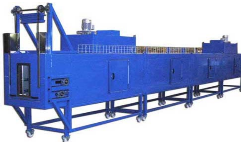
Tunnel air chaud (batteries électriques), convection forcée par turbines. Tunnel composé de 5 modules - 24 kW
