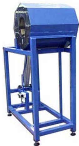
Tunnel infrarouge moyen - 10.4 kW Ouverture par vérin pneumatique. Longueur de traitement : 1100 mm. Fourni avec coffret électrique indépendant
